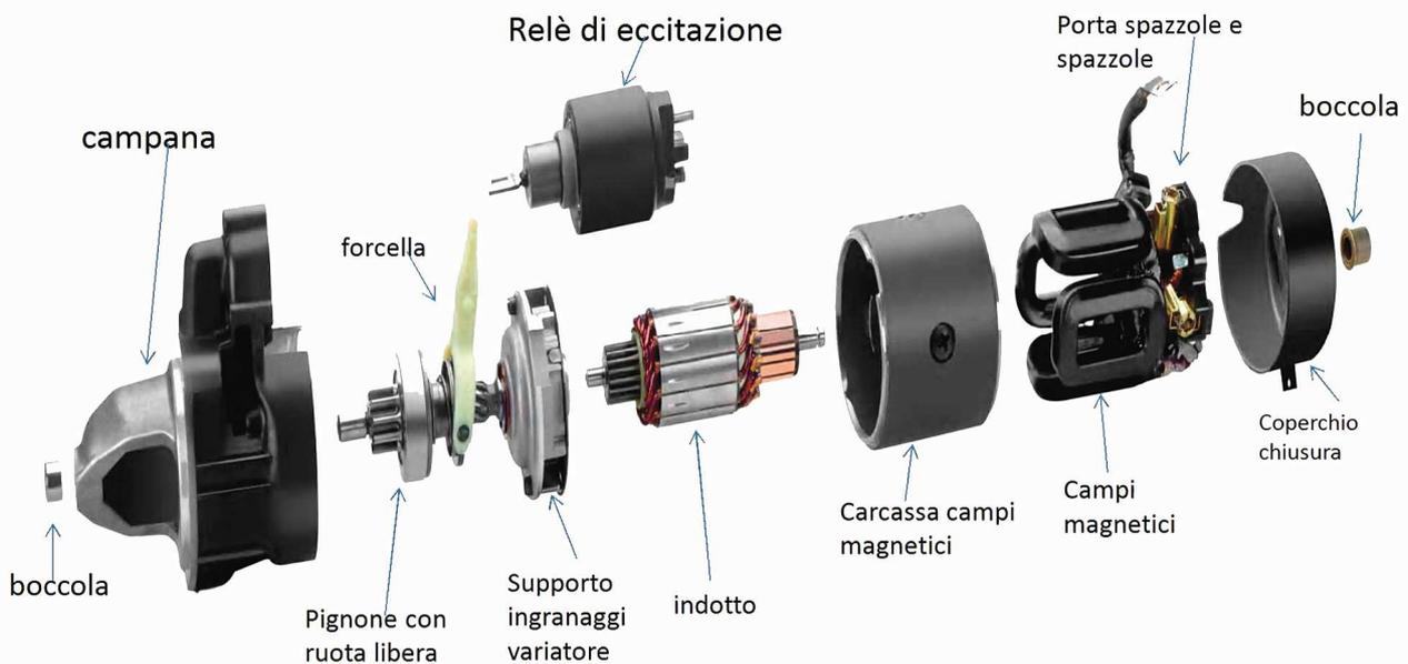
Nell'esploso sopra possiamo facilmente distinguere I componenti di un motorino di avviamento. Durante l'accensione del motore, il solenoide muove il pignone sul braccio di attuazione e ingaggia gli ingranaggi del volano. Quando il motore è avviato, il pignone viene ritirato nella sua posizione iniziale.
