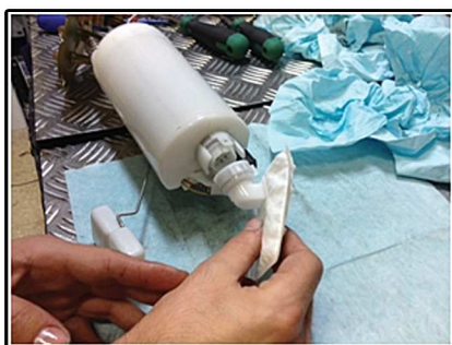
6. Rimontare il filtro carburante
