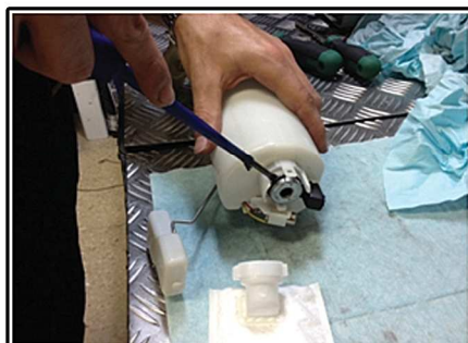
5. Rimontare la valvola all'interno del filtro
