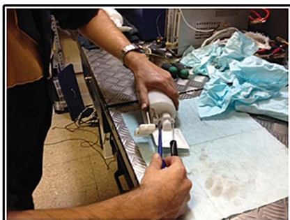
4. Lubrificare il piattello della valvola
