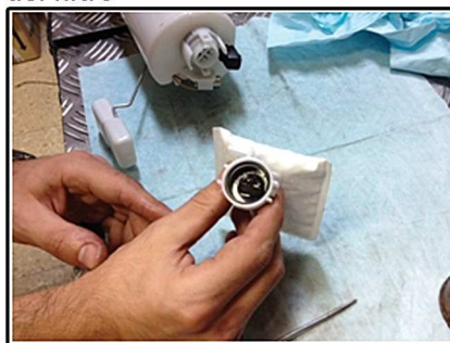
5. Rimontare la valvola all'interno del filtro
