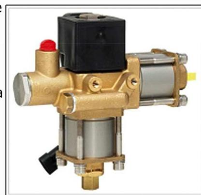
Tutti i regolatori di pressione della nostra gamma sono forniti di un filtro particellare integrato ad alta efficienza (1), una valvola di non ritorno (2) che mantiene l'elevato livello di pressione (quando si arresta il motore o si passa al funzionamento a benzina, ecc.) e una valvola di scarico pressione (6) che interviene in caso di guasto del regolatore. I regolatori vengono riscaldati tramite il liquido di raffreddamento del motore, specialmente in vicinanza degli ugelli (3).
